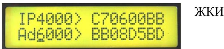
Рисунок 2.10 — Состояние ЖКИ при переходе в режим выполнения программы
