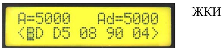
Рисунок 2.13 — Отображение адреса данных в режиме ввода программы
