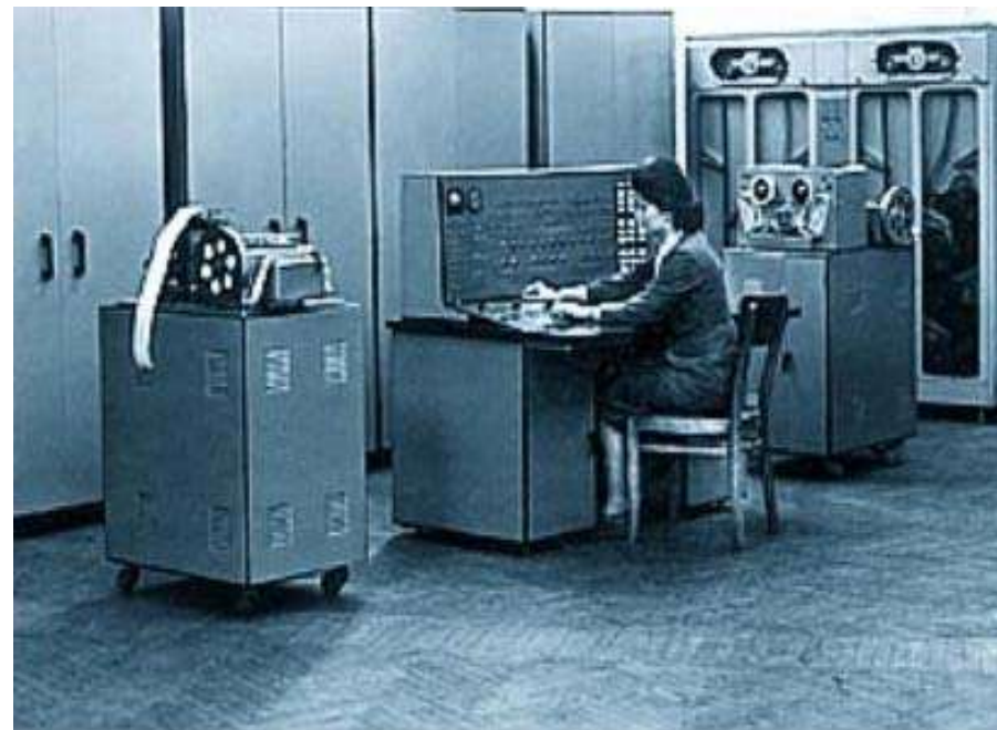
Вычислительная система с программируемой структурой – Минск-222 (создана – 1965 г., система телекоммуникаций – многоканальное кольцо)
