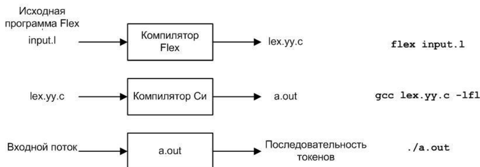
Рисунок 12. Схема использования Flex
