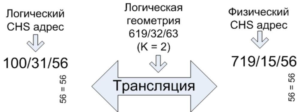
Рис. 35. Преобразование CHS адресов при использовании Large трансляции
