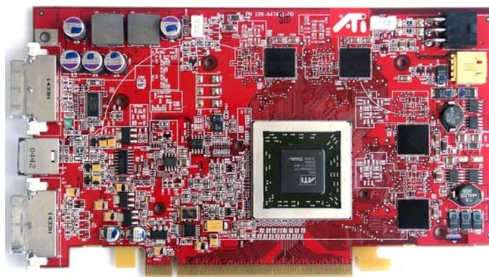
Рис. 27. Вид видеоадаптера (ATI RADEON X850 XT PE)
